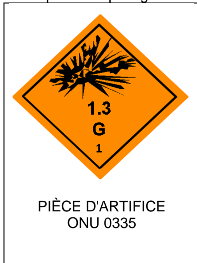
Fig. 1: étiquette de danger pour pièces d'artifice, par ex. bombes sphériques avec effet étoile (calibre < 180 mm) ou batteries.
