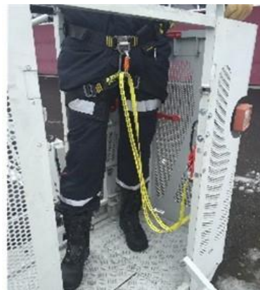
Bild. 9 Montage des Gurtes mit Oberschenkelriemen mittels Karabinerhaken SN EN 362.
